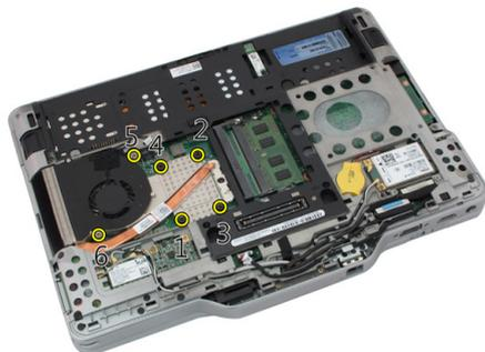
8. Levante el disipador de calor para retirarlo del equipo.
