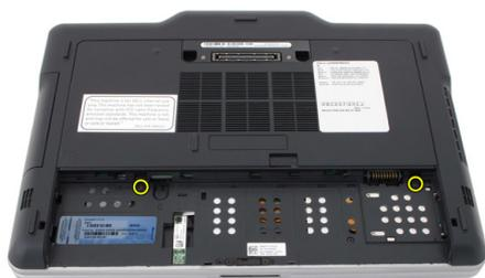
4. Deslice el panel posterior hacia la parte posterior de la computadora y levántelo para retirarlo del equipo.
