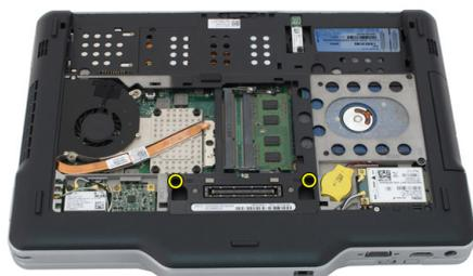
**6.** Dele la vuelta al equipo y extraiga los tornillos que fijan el teclado.
