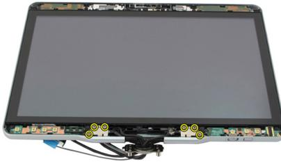
11. Extraiga las bisagras de la pantalla de la cubierta posterior.
