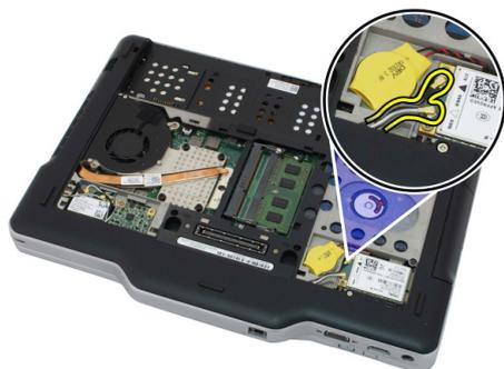
5. Extraiga el tornillo que fija la tarjeta WWAN a la placa base.
