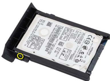
7. Extraiga el soporte de la unidad de disco duro y deslice el caucho de la misma.
