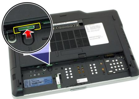
4. Deslice la tarjeta SIM y extráigala de la computadora.
