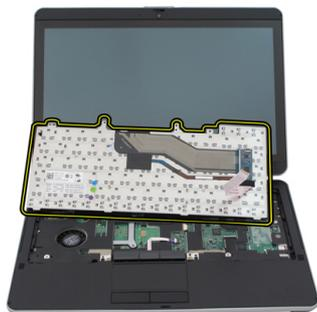
9. Quite la cinta de mylar que fija el cable de datos del teclado a la parte posterior de éste.
