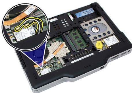
5. Extraiga el tornillo que fija la tarjeta WLAN a la placa base.
