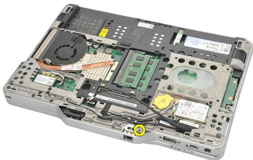
**11.** Levante el soporte del conector para módem y retírelo.
